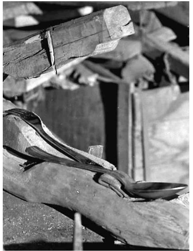
Base in legno per la pulitura della posata (1923-1927) Wooden base for polishing the cutlery (1923-1927) Base en bois pour le nettoyage des couverts (1923-1927)
